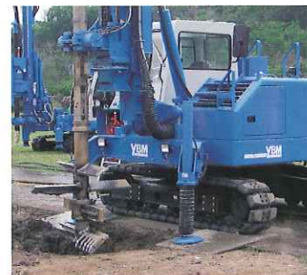
φ1,000mm柱状改良用攪拌ビット
