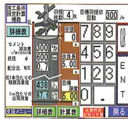
柱状改良 施工支援画面
